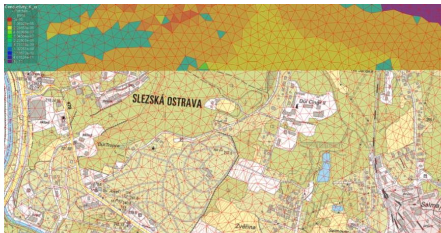
Rozčlenění horninového masivu do elementů s hranou cca 60m
